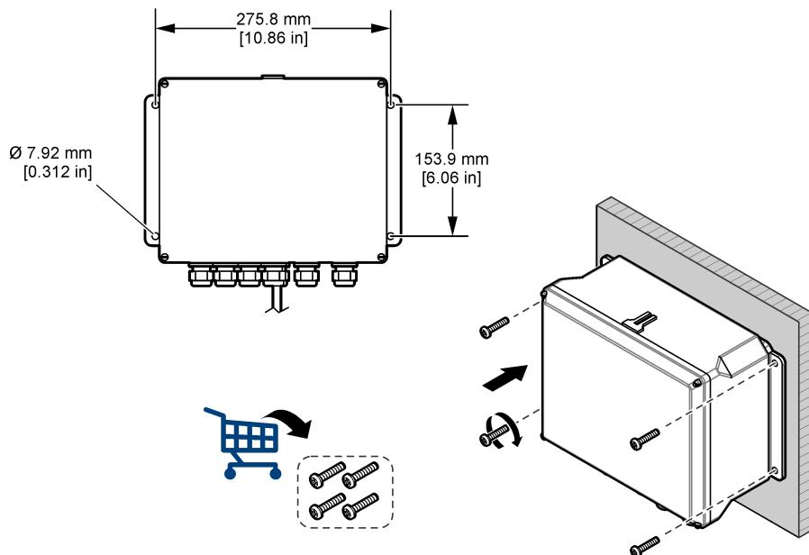
図3 サンプラーの取り付け場所
