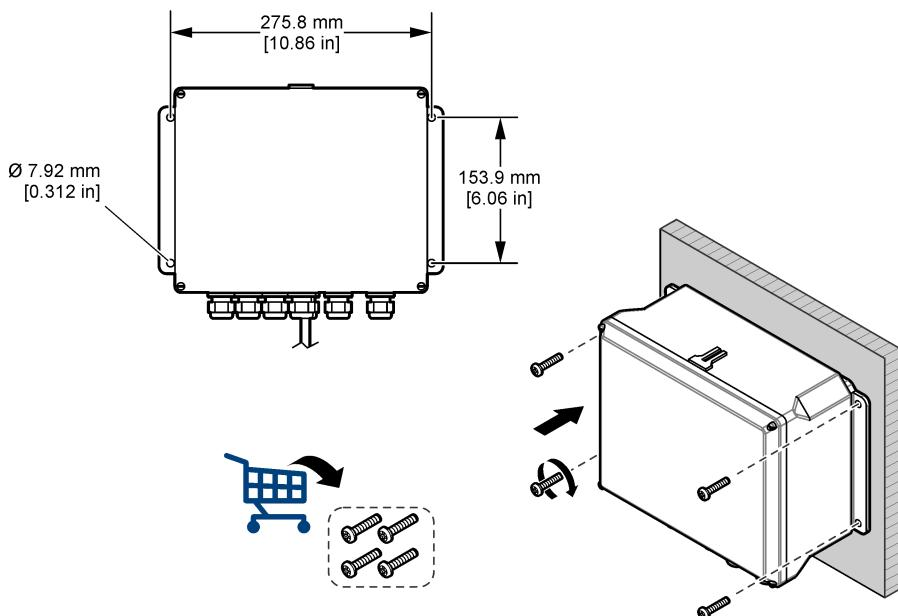
**Figure 3 Emplacements de montage sur l'échantillonleur**
